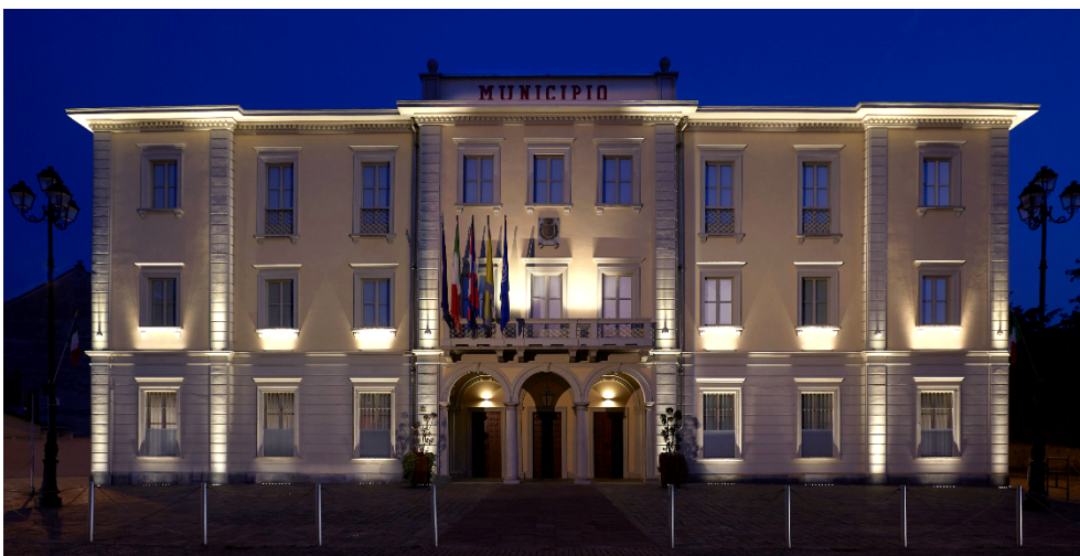
Fig. 7 – Municipio di Nichelino, TO, effetto con luce a proiezione + luce radente, 2021, lighting designer arch. Simona Cosentino.
