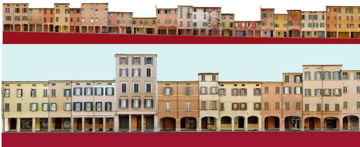
Figura 30. Ortofoto ottenute da modelli 3D: fronti di una via a Bologna.
