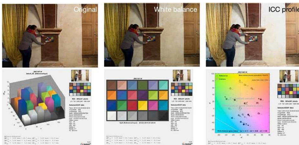
Figura 48. Flusso di lavoro per la correzione radiometrica dei fotogrammi: in alto a sinistra, immagine originale; al centro, bilanciamento dell'immagine con riferimento colore X-Rite ColorChecker Classic; a destra, definizione del profilo ICC. In basso, valutazione del risultato della procedura con il software Imatest Master. Workshop "Colour Measurement and Documentation in Architectural Paint Research", 21-25/10/2019, Estonian Academy of Arts (image courtesy Silvia Bertacchi).
