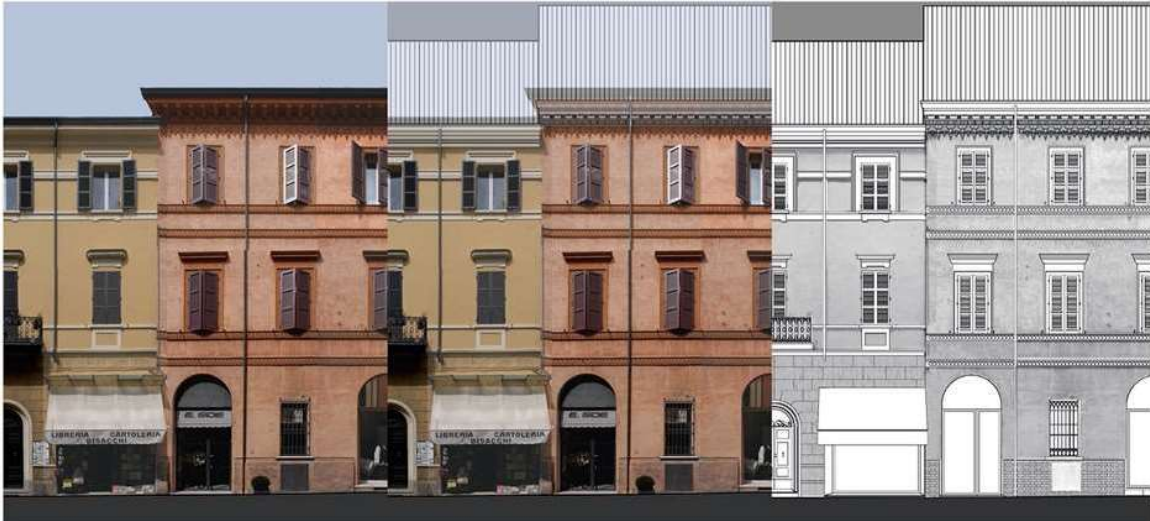
Figura 35. Esempio di mappatura del colore dei fronti urbani mediante disegni con texture mapping fotogrammetrico. Elaborato del rilievo dei fronti urbani di Cesena.
