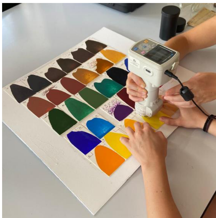
Fig. 2 - Acquisizione dei dati colorimetrici con lo spettrocolorimetro.
