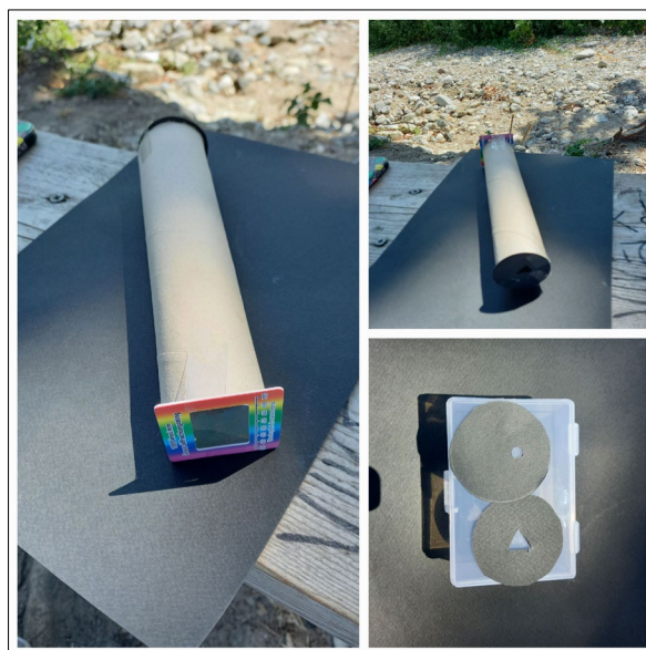
Fig. 4 - Spettroscopio realizzato con materiali di facile reperibilità
